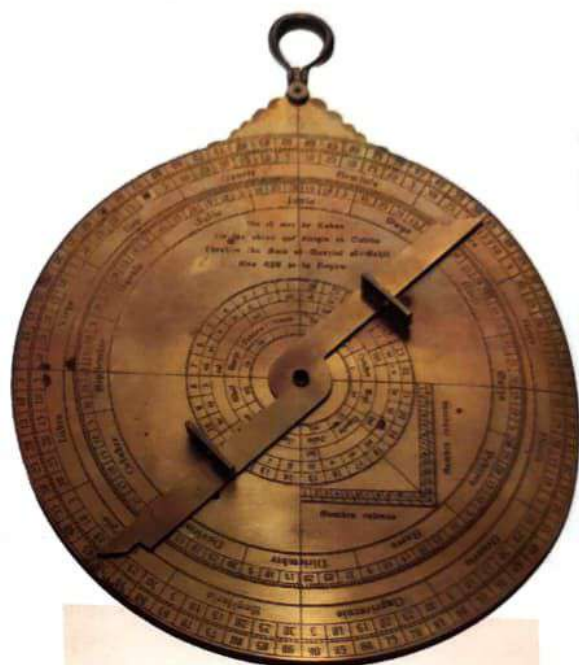
Per orientarsi durante la navigazione, i marinai utilizzavano l' astrolabio , uno strumento astronomico grazie al quale era possibile calcolare la posizione del Sole, della Luna e delle stelle.
